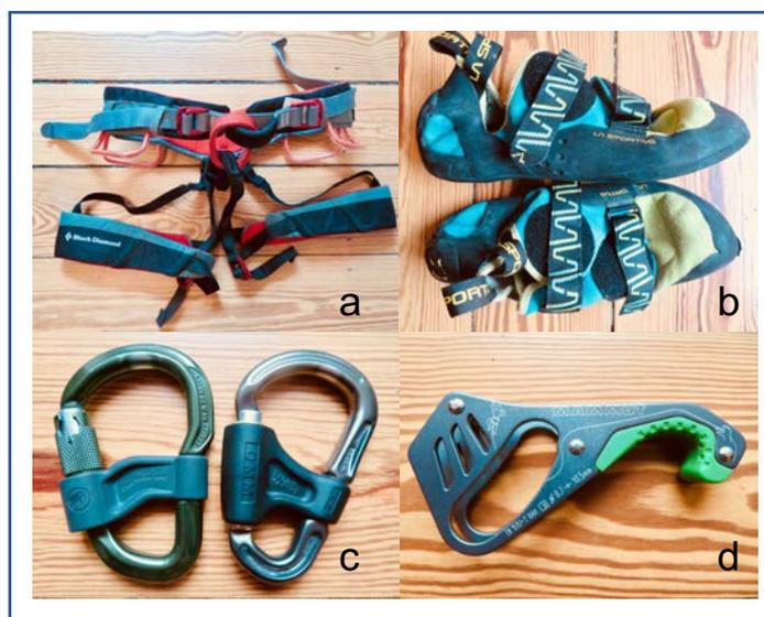
Abbildung 13. Klettermaterial: a) Klettergurt, b) Kletterschuhe, c) HMS-Karabiner, d) Smart-Sicherungsgerät.
